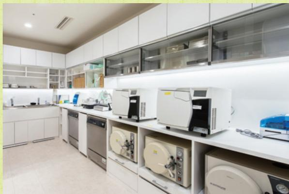
▲ 滅菌室。2台のウォッシャーディスインフェクターと5台の滅菌器が稼働している。
